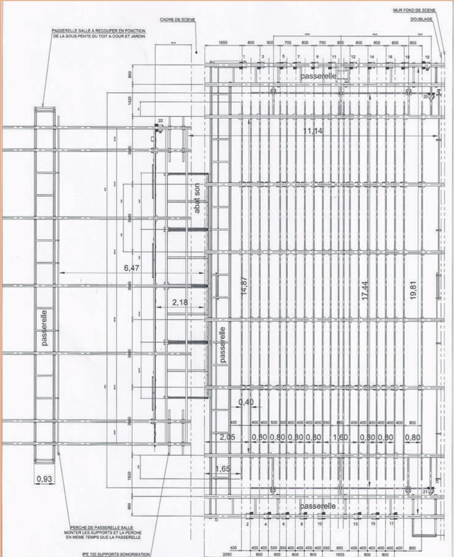
NOTA: SUR LES PERCHES, LE CABLE N°1 EST LE CABLE QUI S'ENROULE SUR LA FLASQUE LA PLUS PROCHE DU M SAUF POUR LES MOTEURS 5 - 12 - 14 - 16 - 19 ET 22 OU IL S'ENROULE SUR LA FLASQUE LA PLUS ELOIGNEE LE CABLE SORT TOUJOURS PAR LE HAUT LES ANTICHUTES SONT TOUJOURS POSITIONNEES DU COTE DE LA DESCENTE DU CABLE
